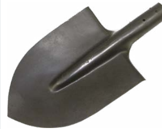
ЛОПАТА ШТЫКОВАЯ ЛКО Б/Ч Материал: сталь 1,6 мм. Покраска: порошковая Сварная тулейка D=36 мм
