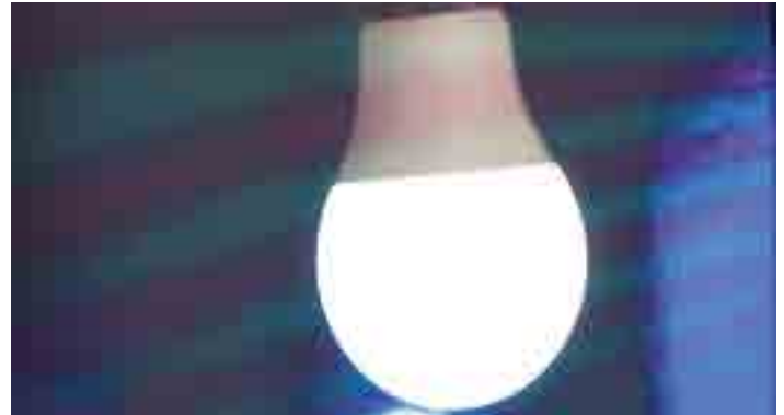
Лампа с пульсацией (проверка с помощью мобильного телефона)
